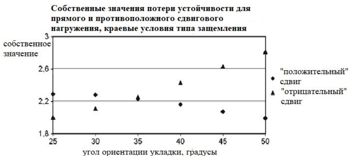
Рис. 5.17. Наименьшее собственное значение устойчивости для двух противоположных нагружений сдвигом, краевые условия типа защемления.
