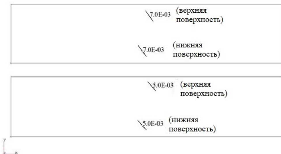
Рис. 6.7. Положение точек максимума деформации сжатия и ее ориентация (верх [[120^\circ]_8]_s , низ [[120^\circ]_6, [0^\circ]_2]_s ).
