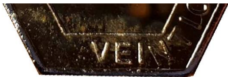
Рис. 12.1. Брак гальванопокрытия на токене в 25 сентаво 2006
