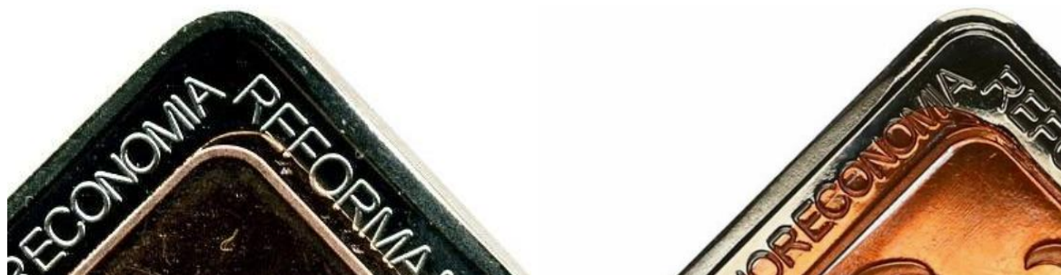
Рис. 33.1. Примеры смещения гальванопокрyтия на токене в 4 реала 2009
