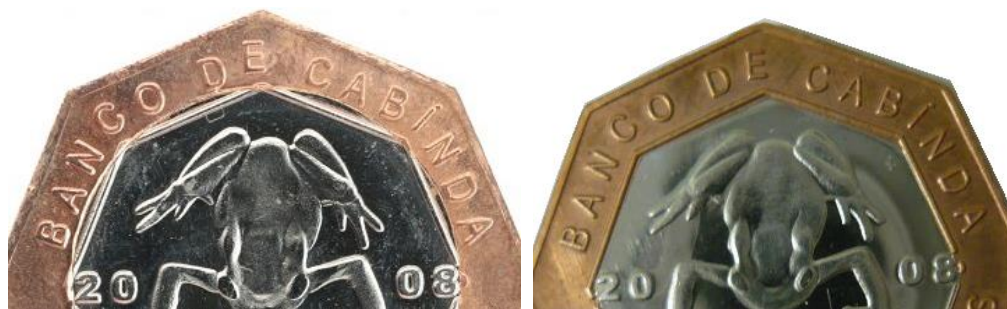
Рис. 24.1. Брак формы гальванопокрытия никелем на токене в 7 ½ эскудо 2008
