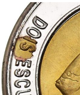
Рис. 6.1. Отсутствие части гальванопокрытия на токене в 2 ½ эскудо 2003
