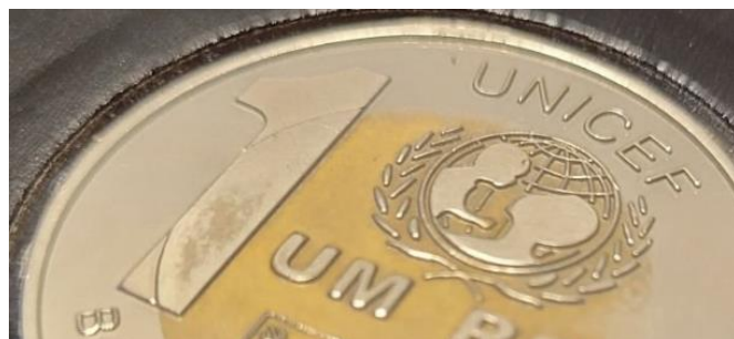
Рис. 42.1. Пример истирания гальванопокрытия на токене в 1 реал 2011
