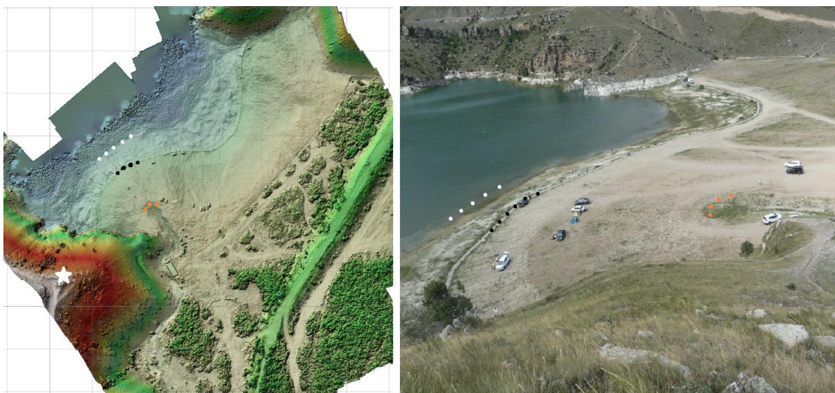
Рисунок 4. Верхний бьеф дамбы хвостохранилища. Слева: цифровая модель местности (2022 г.), в правой части видна отсечная дамба; ориентация на север, шаг сетки 100 м.
