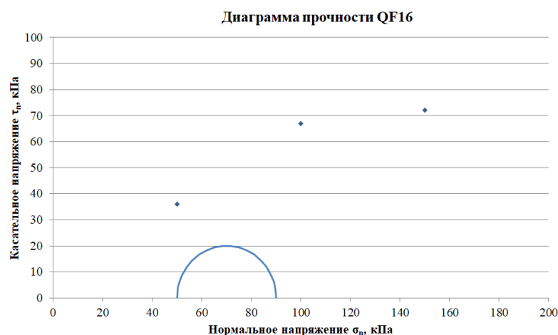
Рисунок П4-2 (продолжение). Сводная диаграмма прочности. Точками отмечены результаты испытаний одноплоскостного среза, круги Мора отражают результаты испытаний трехосного сжатия.
