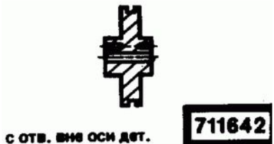
Код классификатора ЕСКД 711642 / Общероссийский классификатор изделий и конструкторских документов / Детали - тела вращения типа колец, дисков, шкивов, блоков, стержней, втулок, стаканов, колонок, валов, осей, штоков, шпинделей и др. / С L до 0,5 D вкл. с нар. поверхностью цилиндрической / С закрытыми уступами, без наружной резьбы / С центр. сквоз. отв., круг. в сеч., цилиндр. без резьбы, гладким / Без кольц. паз. на торц., без паз. на нар. пов., с отв. вне оси дет.
