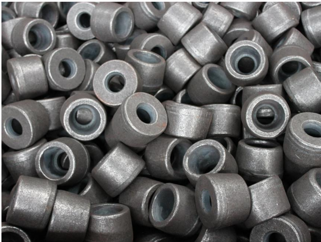
Рисунок 4.2 – Поковка стальная круглая ГОСТ 7829-70.
