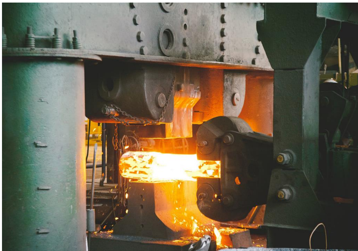
Рисунок 4.3 – Обработка поковки из стали, ГОСТ 8479-70.
