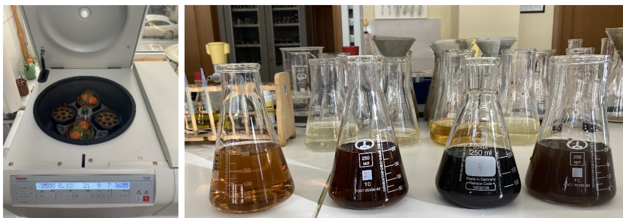
Фото. Получение водных вытяжек методом центрифугирования
