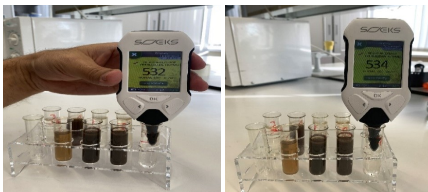
Фото. Определение нитрат-ионов с помощью прибора «Созэкс Эквизор F4»
