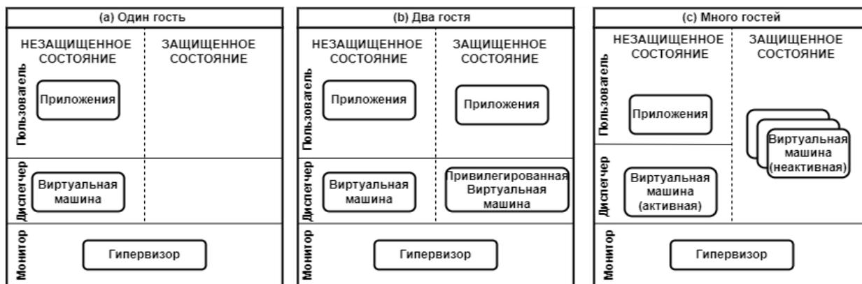
Рисунок 1 – Виртуализация с помощью TrustZone для ARM
