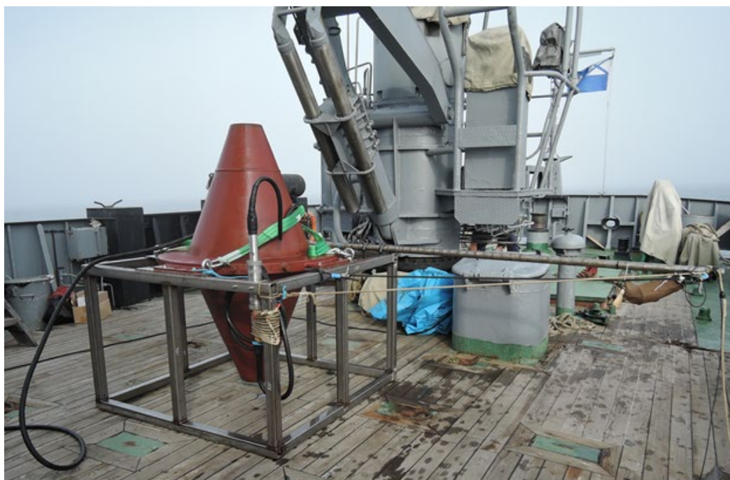
Рис. 7. НЧИ с установленной на опоре штангой с контрольным гидрофоном.
