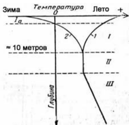
Рис. 5. Распределение температуры в глубине грунта
