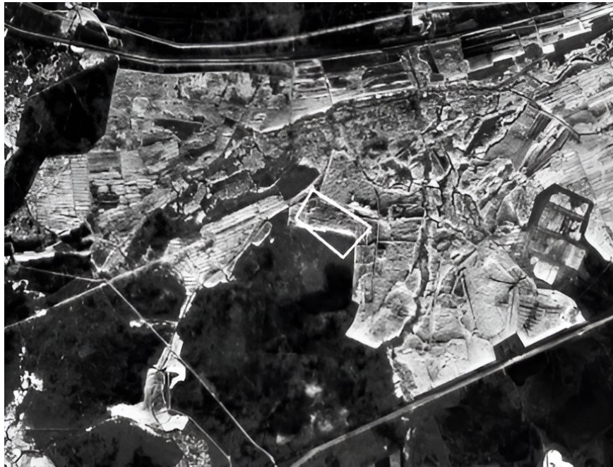
Рис. 1 Построение перспективной проекции изображения с камеры на спутниковый снимок в виде четырехугольной рамки
