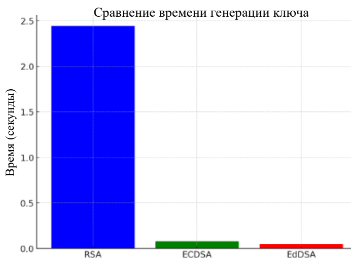
Рисунок 1 – Время, затраченное на генерацию ключа для RSA, ECDSA, EdDSA
