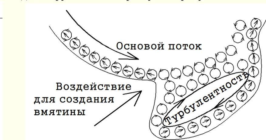
Рис. 5. Обтекание основным потоком вмятины в трубопровод.
