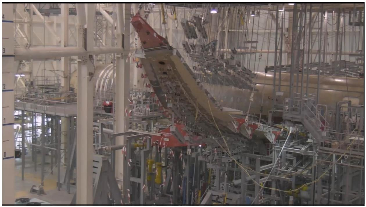
В прочностных расчётах композитного крыла компоненты тензора деформаций Грина полагаются малыми, а перемещения, в отличие от металлического крыла, следует считать не малыми, а умеренными. Это означает, что в тензоре деформаций Грина необходимо учитывать и
