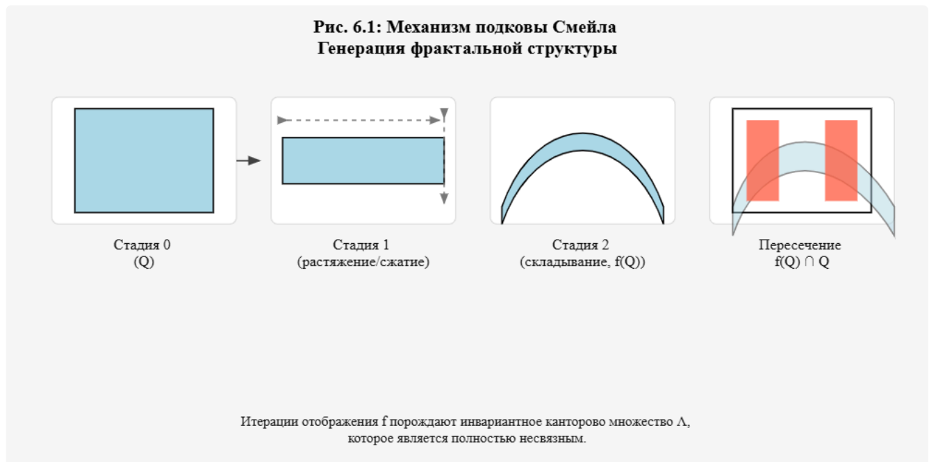
Рис. 6.1. Схематическое изображение механизма Подковы Смейла. Трансверсальное пересечение инвариантных многообразий порождает фрактальное инвариантное множество (Множество Кантора) и хаотическую динамику (Сдвиг Бернулли).
