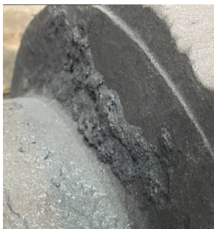
Рисунок 9. Пригар при использовании Zirkofluid 1219B
