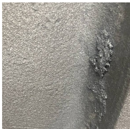
Рисунок 10. Пригар при использовании ПК-50А
