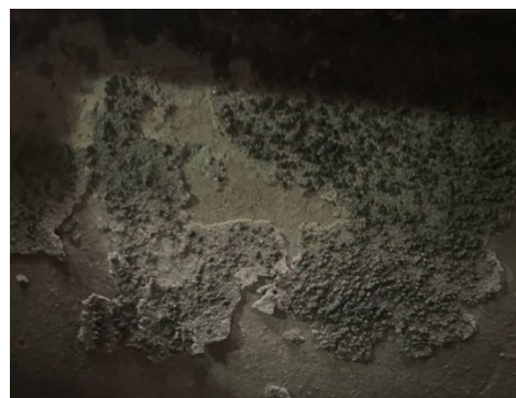
Рисунок 12. Очистка дробью S780
