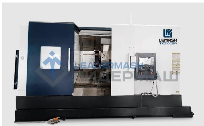
Рис. 12 Обрабатывающий центр с ЧПУ LEMASH TK3100SY
