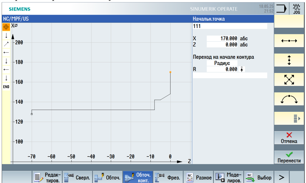
Рис. 63 Контур обработки детали на операции 010 Уст. А
