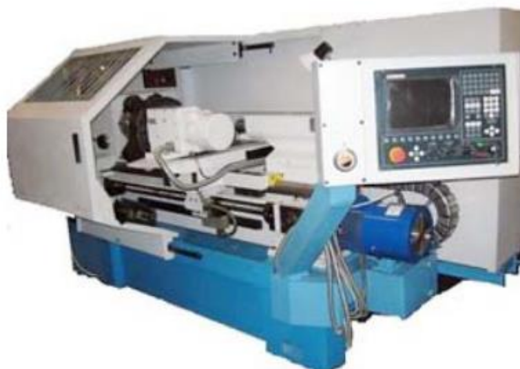
Рис.1.15 Станок токарный патронно-центровой с ЧПУ
