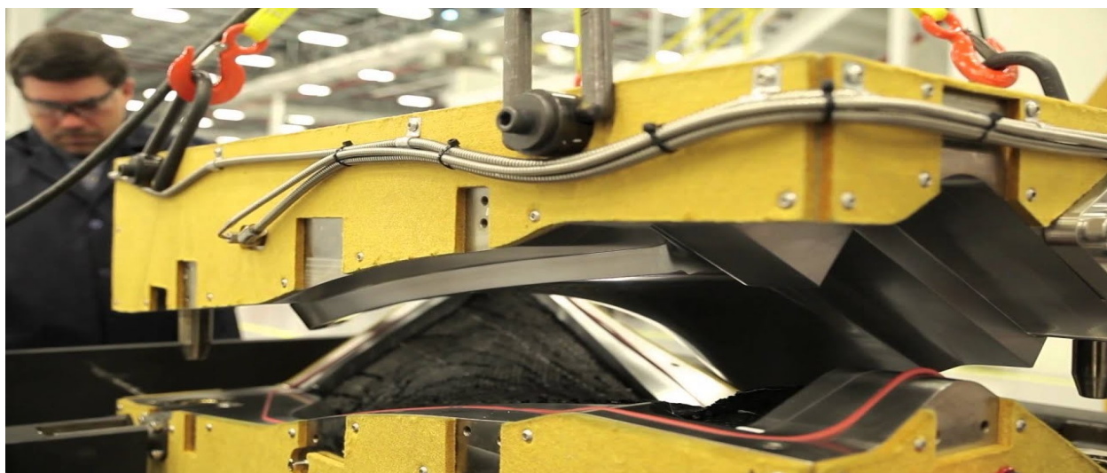
Рисунок 1.2 – Метод RTM в реальных условиях
