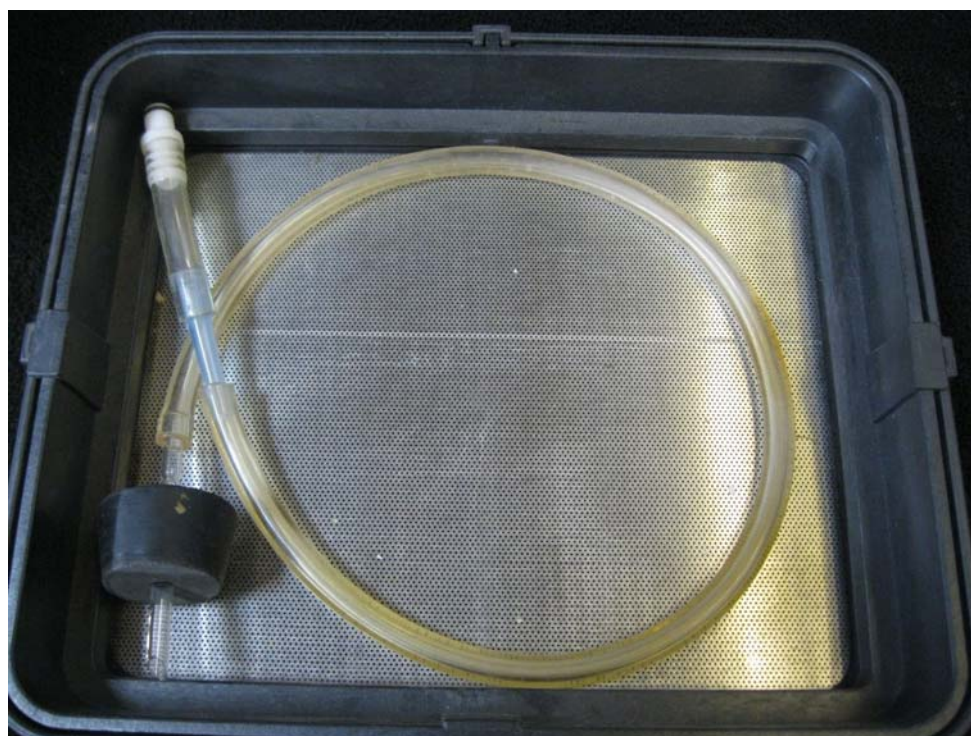
Илл. 1: Один из ранних простых вакуумных блоттеров (1990): trans-Vac™ TE-80 (Hoefer Scientific Instruments, San Francisco).
