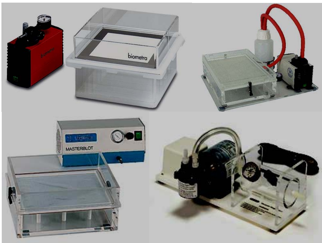
Илл. 5: Современные конструкции вакуумных блоттеров с контролем вакуума.
