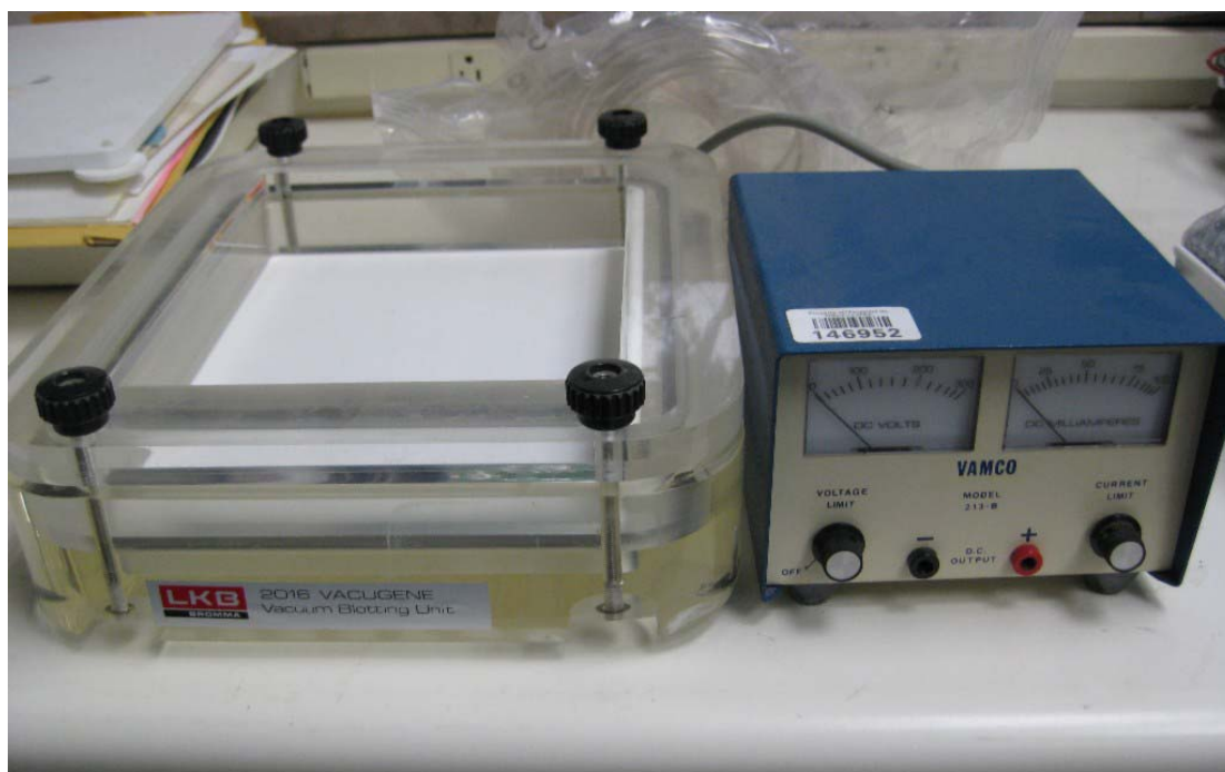
Илл. 2 а: Камера для вакуумного блоттинга (vacuum blotting unit) «LKB Bromma» VACUGENE 2016 с источником питания VAMCO.
