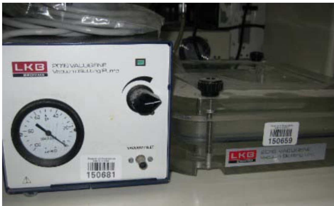
Илл. 2 а: Камера для вакуумного блоттинга (vacuum blotting unit) «LKB Bromma» VACUGENE 2016 с аутентичным насосом.
