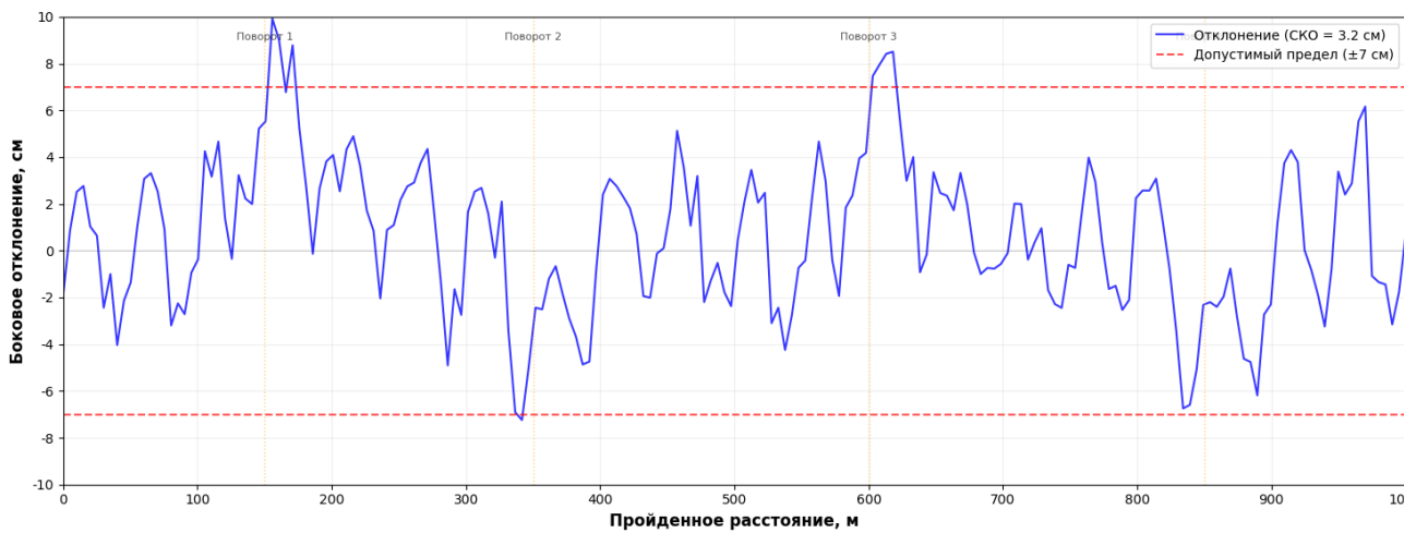
Рисунок 4. Зависимость боковых отклонений от пройденного пути для анализируемого участка. а) прямой участок, б) участок с поворотами
