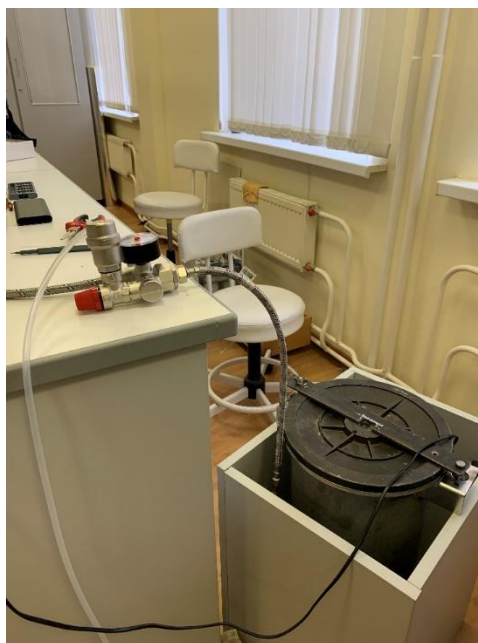
Рис.2. Емкость, корпус автоклава и предохранительный клапан.
