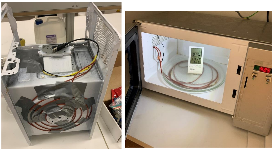
Рис.3. Внутренняя часть термостата с нагревательным кабелем и готовый образец.
