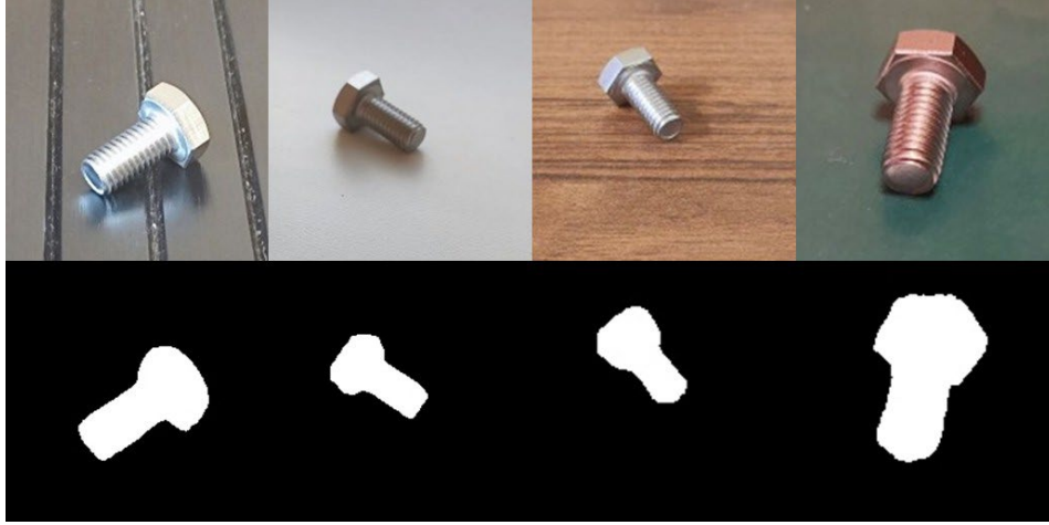
Рис. 4. Сегментация экземпляров: первая строка содержит RGB-изображения, вторая – бинарные маски, определенные по выходным данным YOLOv8
