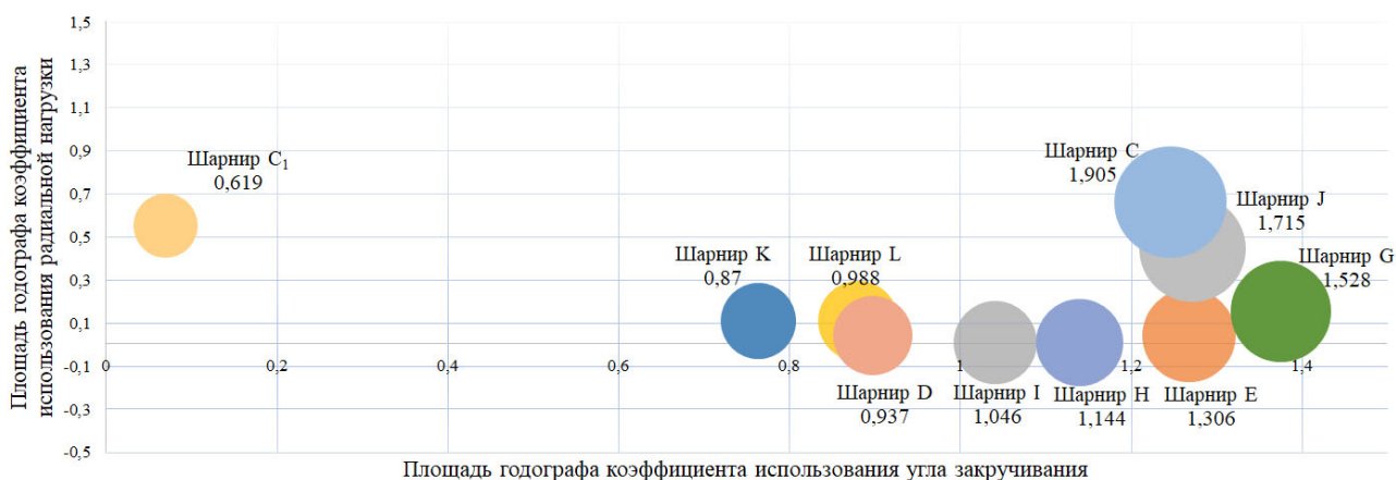
Рисунок 4 – Диаграмма комплексной интегральной оценки нагруженности упругих шарниров механизма привода очистки
