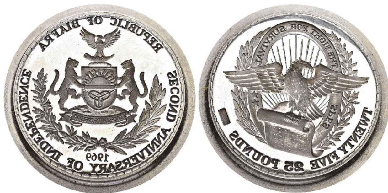
Рис. 12.5. Оригинальный штемпель для золотой монеты в 25 фунтов 1969
